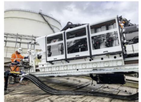
Vorschubschlitten mit wirkungsgradoptimierten Elektromotoren in IP69K
